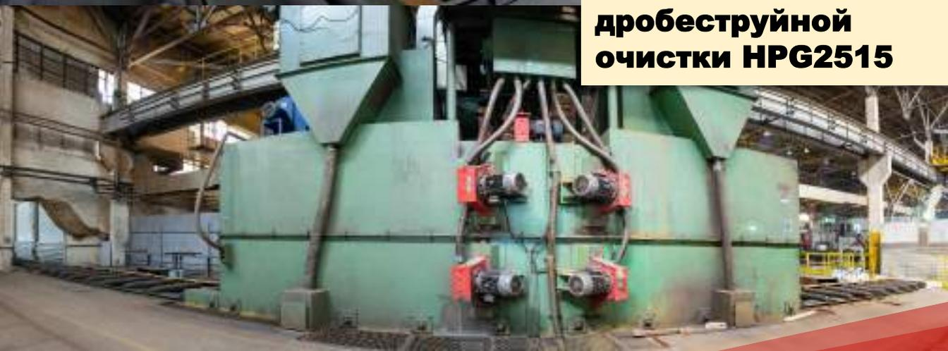
Дробеструйная машина – напорная пневматическая установка, создаёт направленный поток воздуха, выходит вместе с абразивной взвесью, очищая поверхность металлических заготовок.
