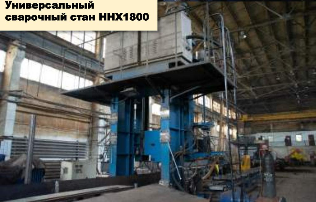
**Технологическая линия для производства сварной двутавровой балки с использованием технологии тандем сварки**
